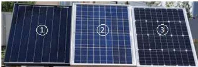
1-himoya qoplamasi qora rangli monokristall PV moduli, 2-polikristall PV moduli, 3-himoya plyonkasi oq rangli monokristall PV moduli.
