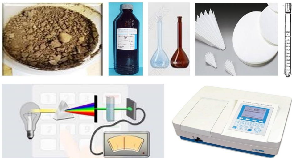
14-rasm. Tuproq tarkibidagi ammoniy azotini Nessler reaktivi yordamida aniqlash uchun zaruriy reaktiv va asbob uskunalar.
